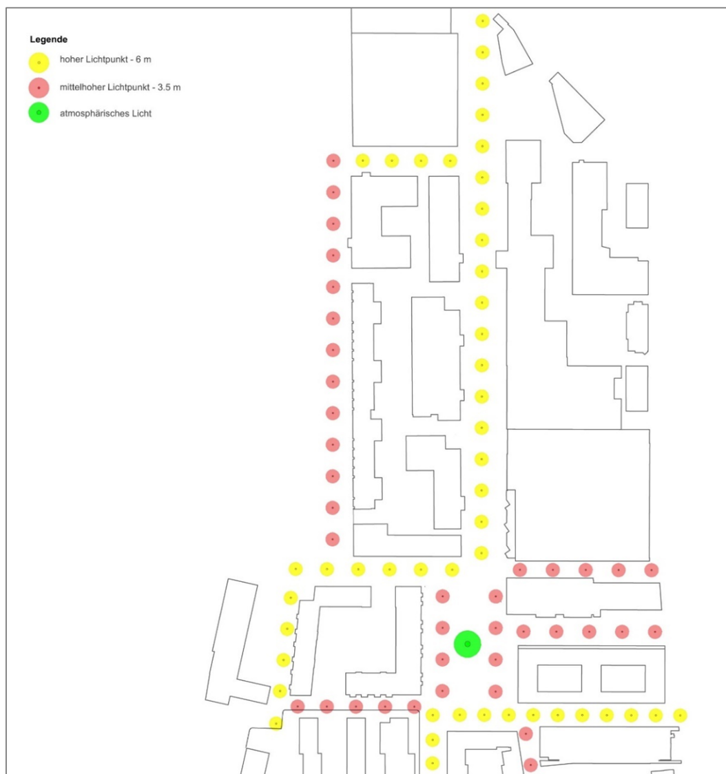
Abb. 19: Beleuchtungsschema, Regelwerk VoltaNord
